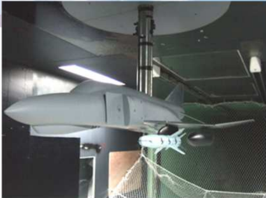
동안정 미계수 측정 실험 (Dynamic Stability Derivatives Measurement)
