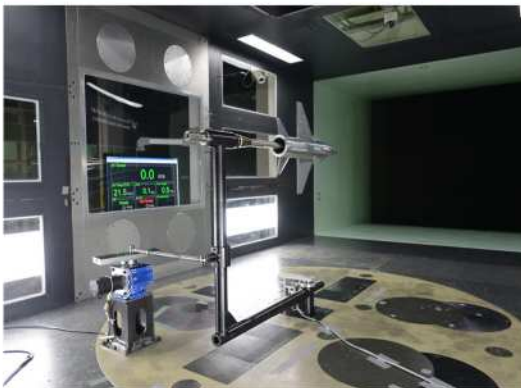
동안정 미계수 측정 실험 (Dynamic Stability Derivatives Measurement)
